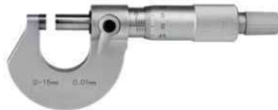
Figura 1.7. El calibrador micrométrico se emplea para hacer medidas aproximadas de longitudes muy cortas.
