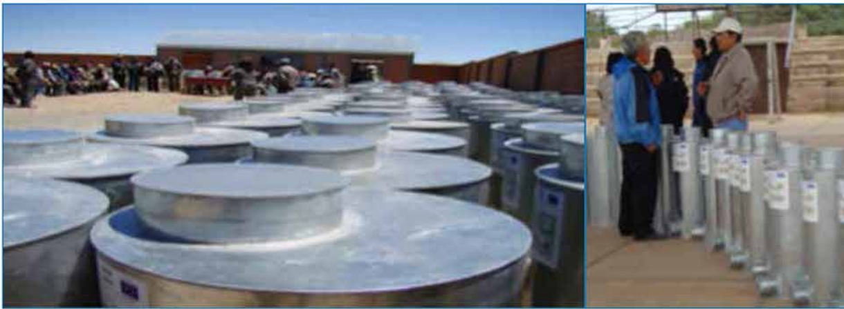
Silos metálicos para la conservación de semillas y alimentos.
